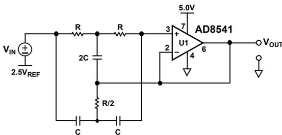
Figure 37. 60 Hz Twin-T Notch Filter, Q = ∞ (Ideal)
